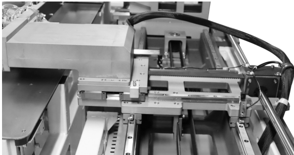
普通贴袋机 非正常关机或误触后，会有一定几率撞机 PK 快速换模贴袋机 专利误触防撞技术，真正实现：永不撞机。
