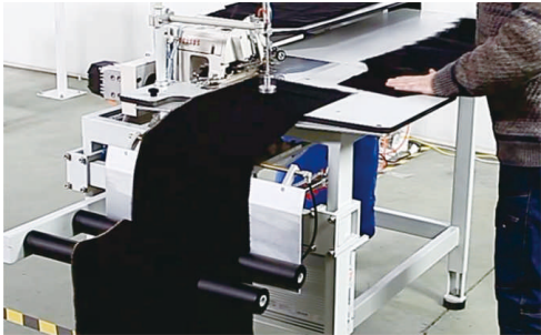
自动收料装置 Automatic stacker
