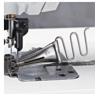
QB 包边机构 QB wrapping construction
