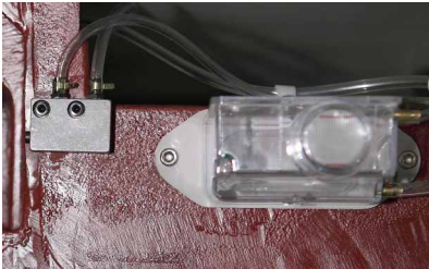
旋梭微量供油 rotay hook mini-oil
