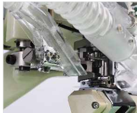
改进式断线刀具，安全不打手
