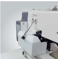
电机抬压脚 Motor presser foot
